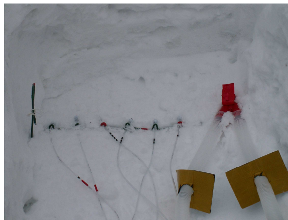
Obrázek 9 Příprava senzorů pro měření koncentrace CO 2 po ukončení experimentu fáze NP
